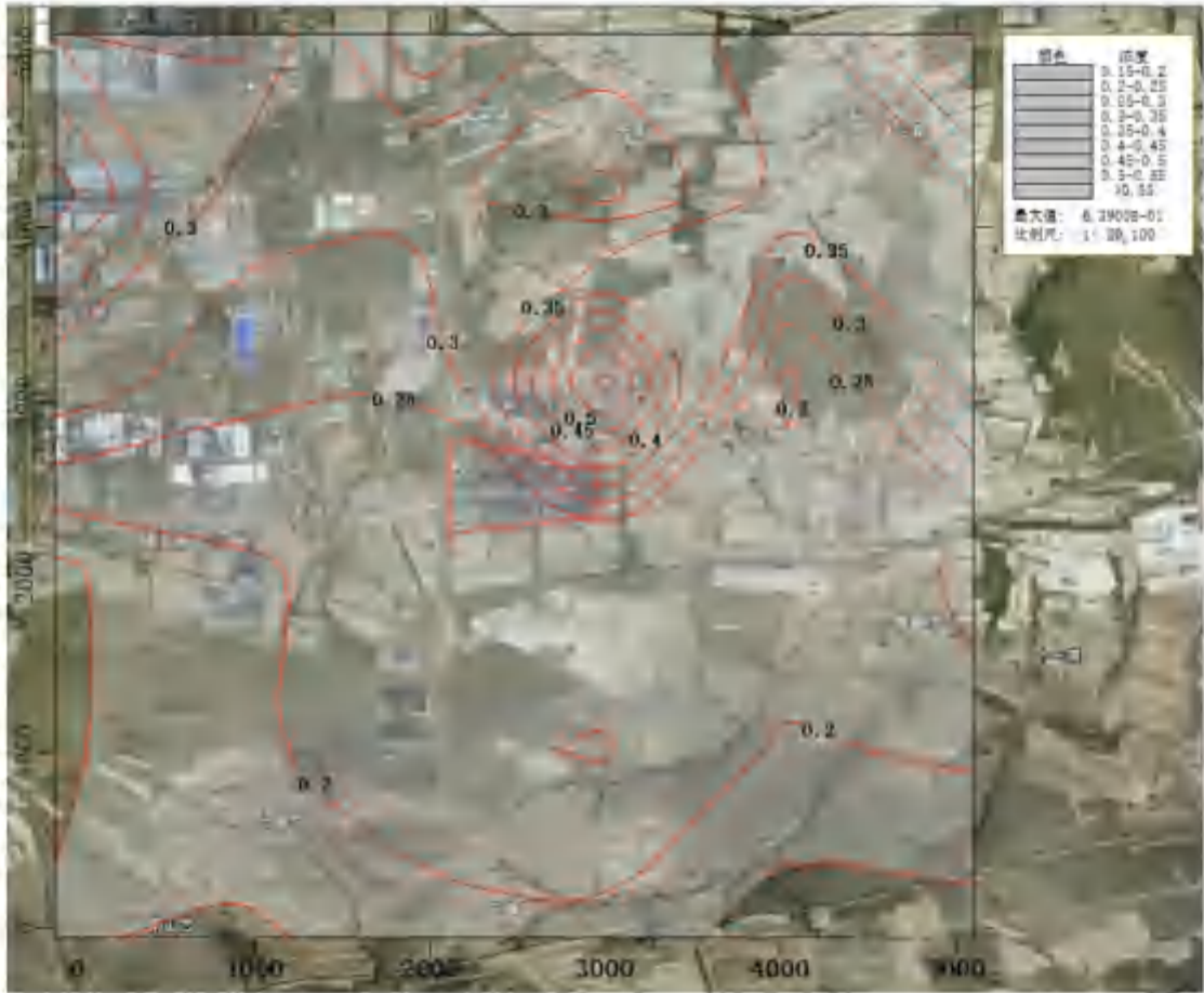
图 5.1-25 PM 2.5 非正常工况下最大 1h 浓度等值线图 (mg/m 3 )
