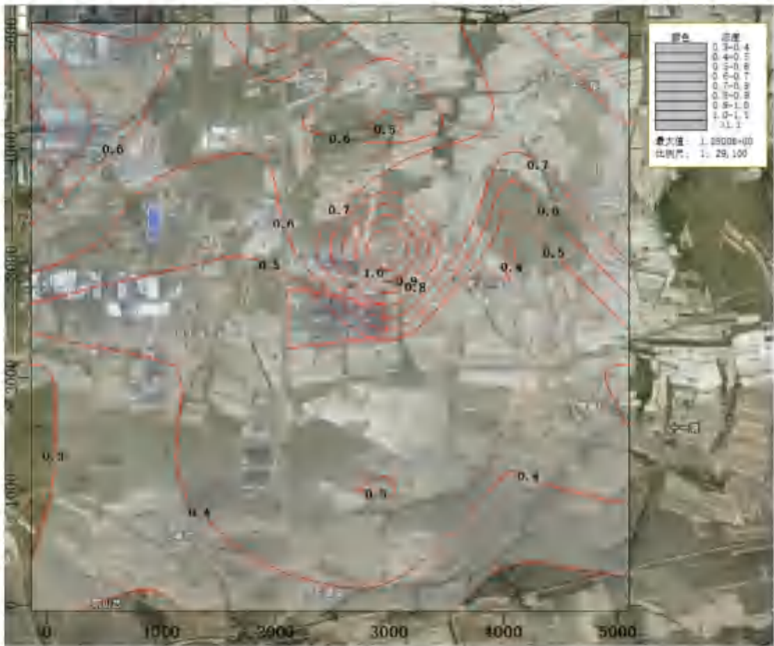
图 5.1-24 PM 10 非正常工况下最大 1h 浓度等值线图 (mg/m 3 )
